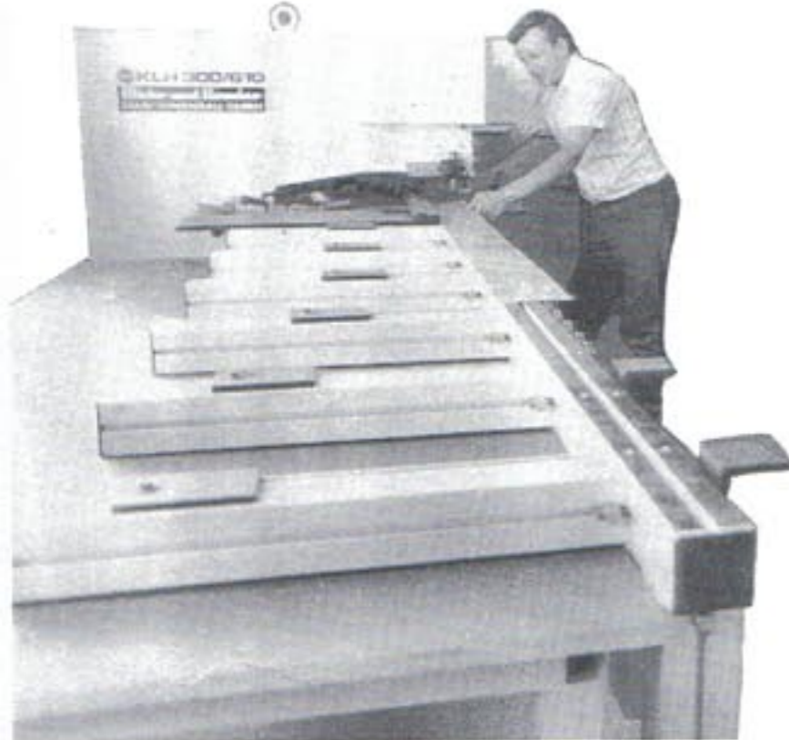
Mit enormer Kraft: Die Druckkraft dieser Stanzmaschine beträgt 30 Tonnen. Fotos: Wagner
