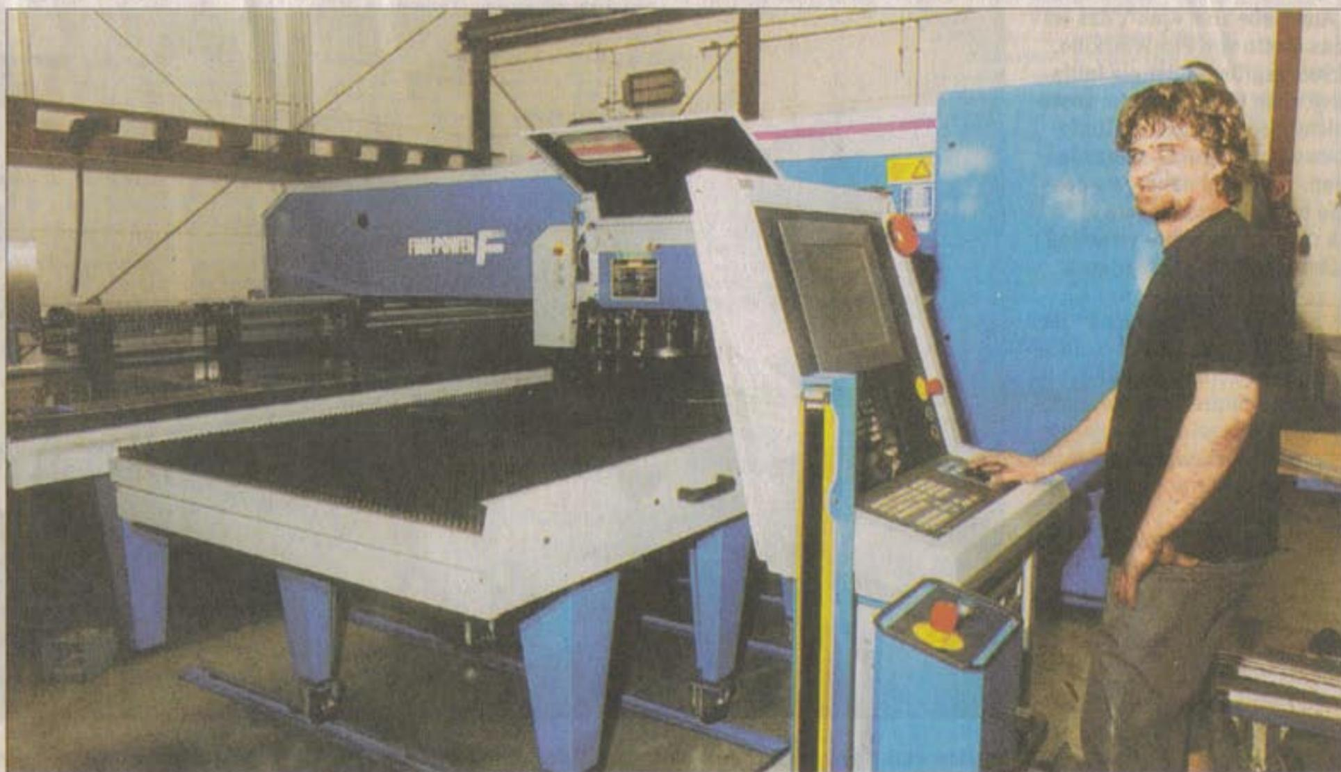
Mit einem modernen High-Tech-Maschinenpark und dem nötigen Know-how hat sich die Alfred Vankorb GmbH in Laufersweiler neue Betätigungsfelder erschlossen. Mit dieser Stanz- und Nippelmaschine mit 20 Werkzeugstationen für Rund-, Lang- und Quadratlochung und einer Stanzkraft von 300 Kilonewton lassen sich Bleche mit einer Stärke von sechs Millimetern und einer Länge von drei Metern verarbeiten. ■ Foto: Gisela Wagner
